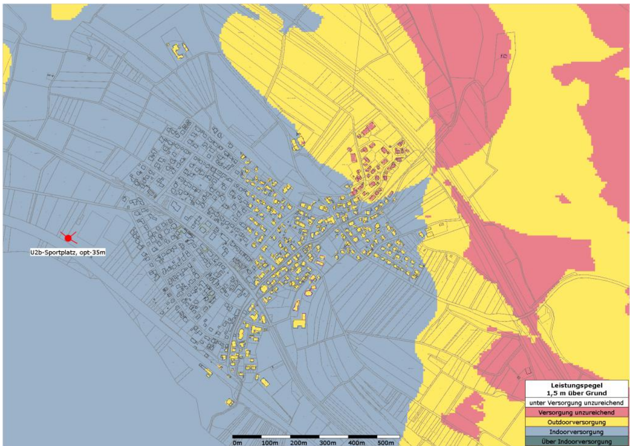
Abb. 1: UMTS-Funkversorgung für 35 m Mast Sportplatz
