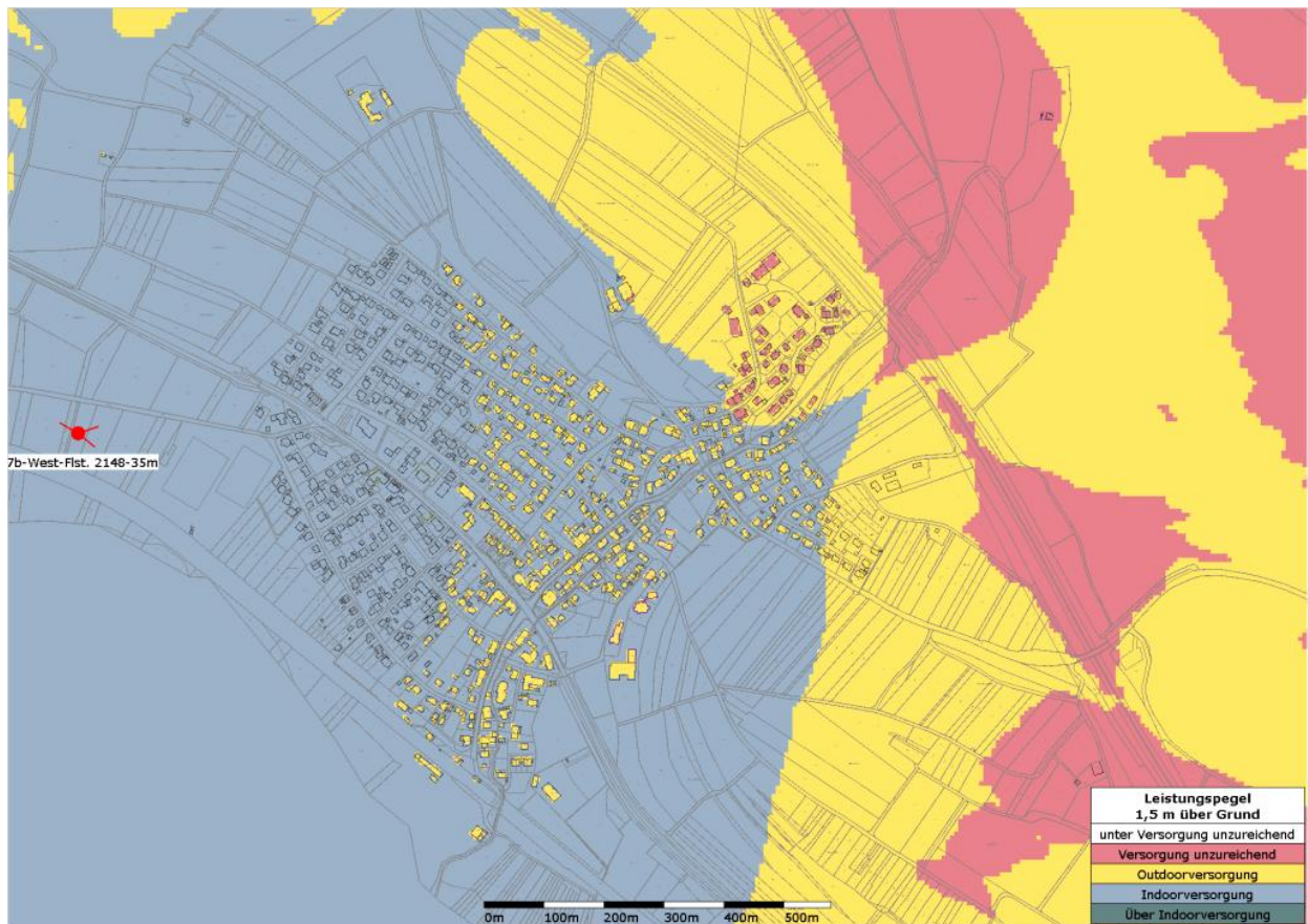
Abb. 2: UMTS-Funkversorgung für 35 m Mast auf FSt. 2148
