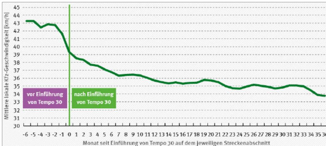
Abb. 2: Verlauf mittlerer Kfz-Geschwindigkeit vor/nach T30-Anordnung in Monaten (Quelle: UBA)
