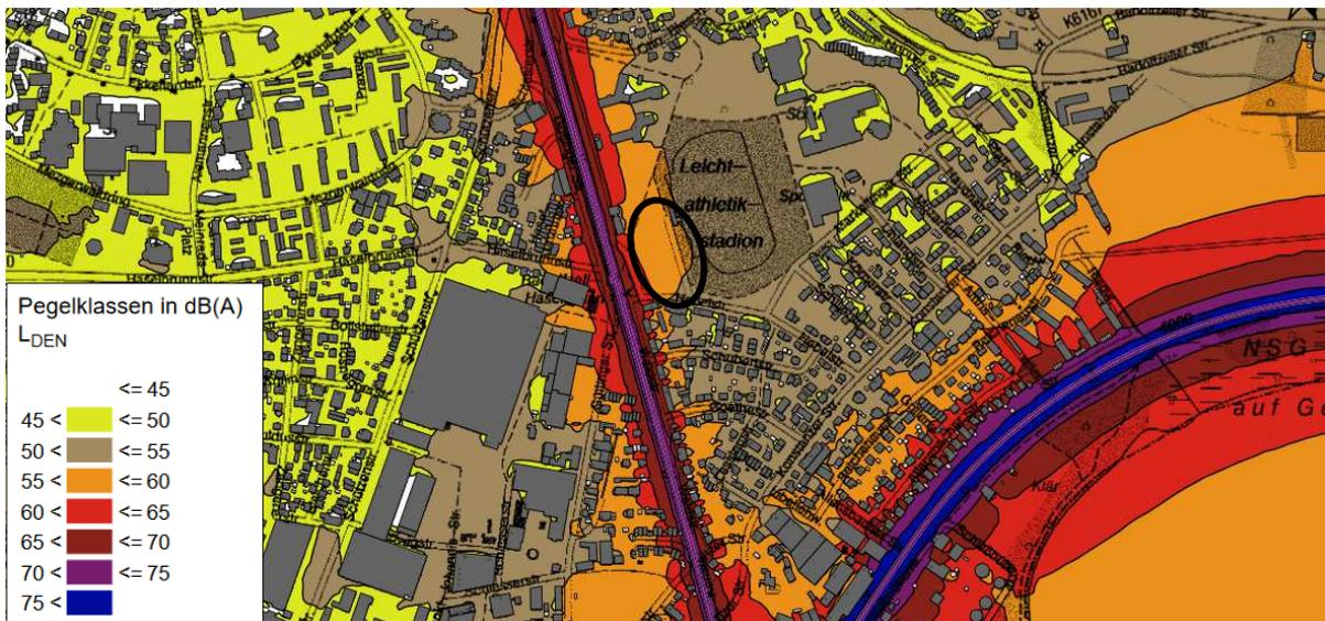
Abbildung 9: Auszug aus dem Lärmaktionsplan der Stadt Radolfzell, Rasterlärmkarte Schienenverkehr, L<sub>DEN</sub> Kernstadt
