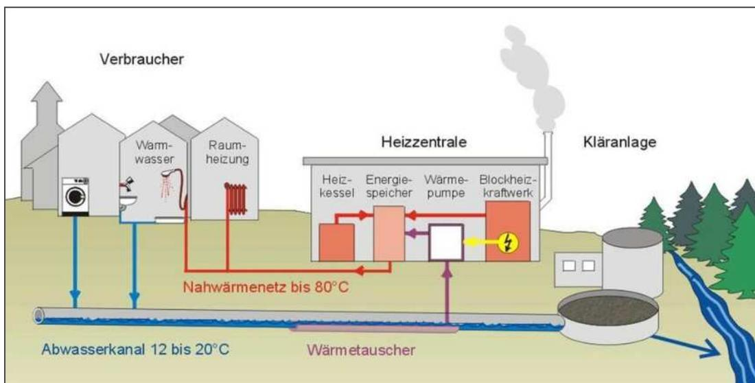
Abbildung 4-6: Nutzung von Abwasserwärme [www.um.baden-wuerttemberg.de/de/energie/energieeffizienz/abwasserwaermenutzung/]
