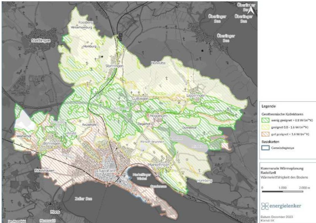
Abbildung 5-7: Ausschnitt aus dem Energieatlas des Landes Baden-Württemberg - Erdwärmekollektoren [LGRB]
