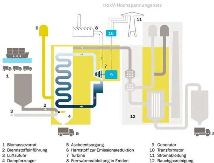
Abbildung 4-3: Prinzip Wärmeerzeugung durch den Einsatz von Biomasse
