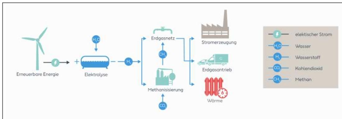
Abbildung 4-10: Das Prinzip von „Power-to-Gas“ [Fraunhofer Institut]
