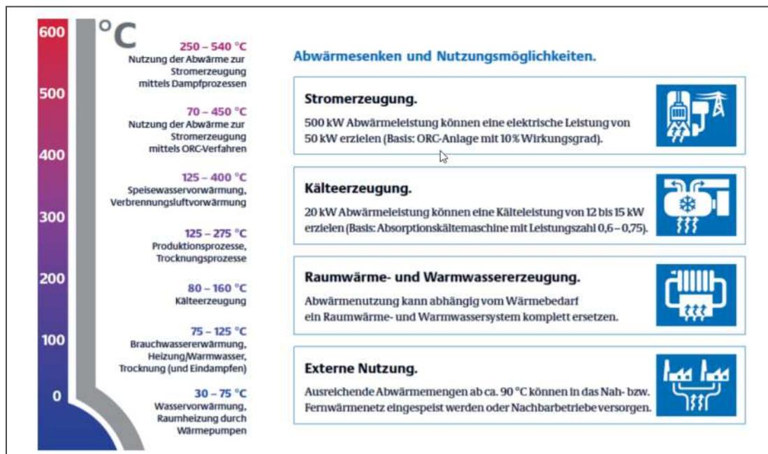
Abbildung 4-8: Nutzung von industrieller und gewerblicher Abwärme in Abhängigkeit vom Temperaturniveau [dena]
