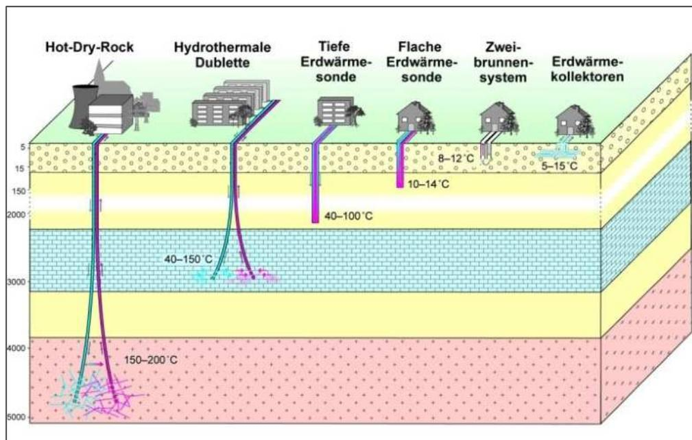
Abbildung 4-5: Wärmeerzeugung durch die Nutzung von Geothermie ([www.lfu.bayern.de/geologie/geothermie/index.htm](http://www.lfu.bayern.de/geologie/geothermie/index.htm))
