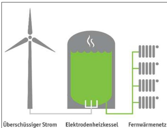
Abbildung 4-9: Funktionsweise Elektrodenheizkessel [Stadtwerke Flensburg]
