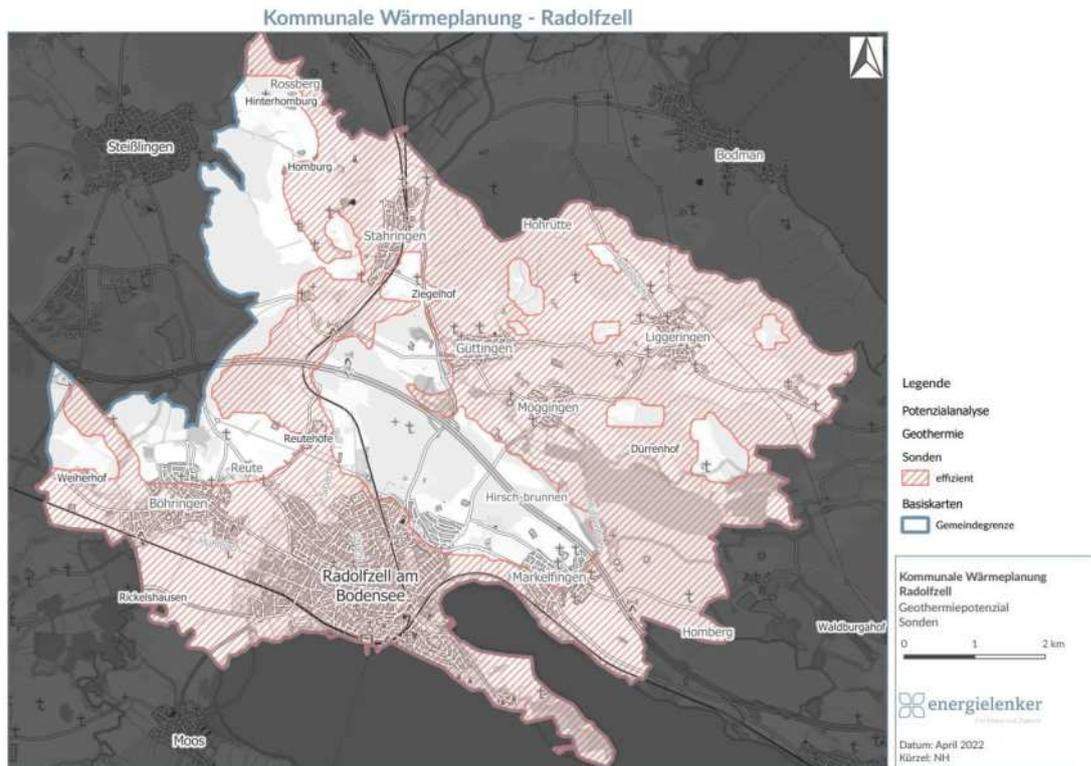
Abbildung 5-8: Ausschnitt aus dem Energieatlas des Landes Baden-Württemberg - Erdwärmesonden [LGRB]
