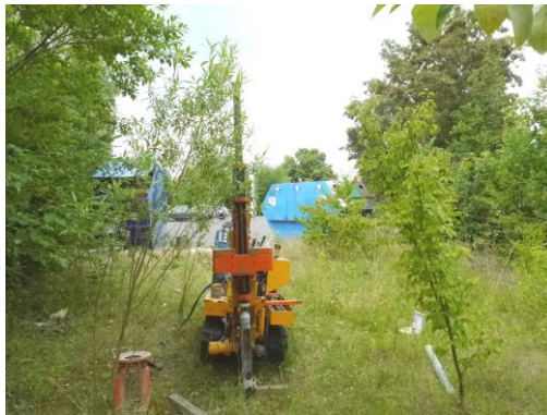
Abb.14: Rammkernsondierung am Ansatzpunkt RKS 12/14
