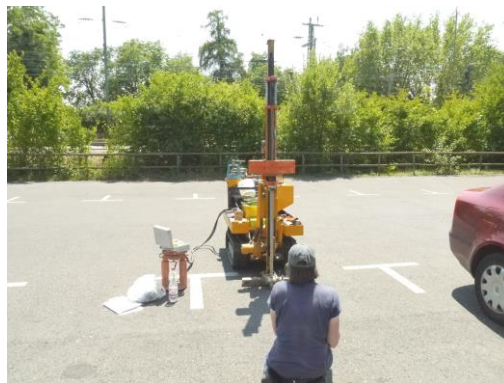
Abb.20: Schwere Rammsondierung am Ansatzpunkt DPH 4/14
