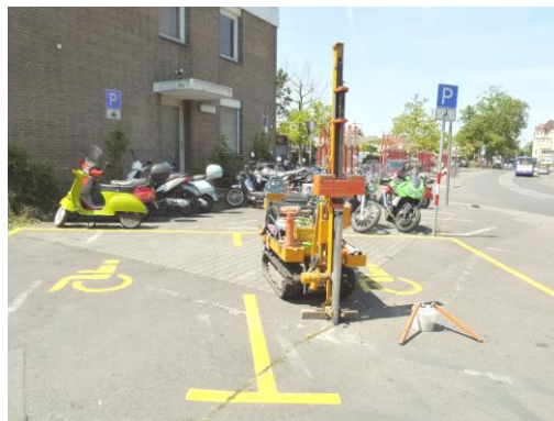
Abb.3: Rammkernsondierung am Ansatzpunkt RKS 1/14
