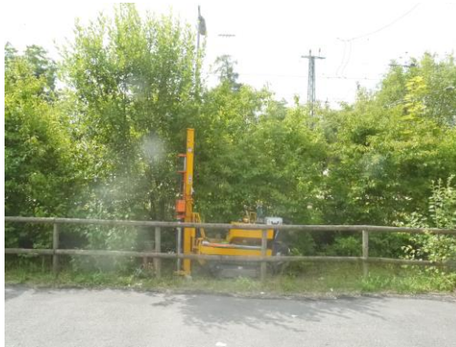
Abb.11: Rammkernsondierung am Ansatzpunkt RKS 9/14
