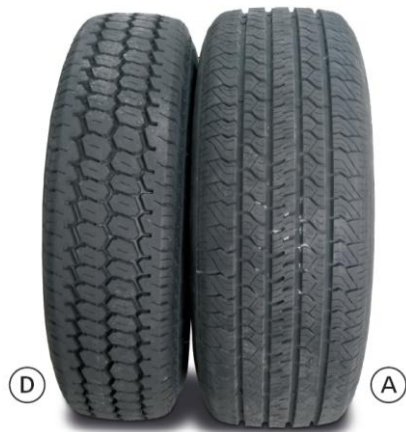
Abbildung 5. Verwendete Messreifentypen gemäß ISO/CD 3rd 11819-2.
