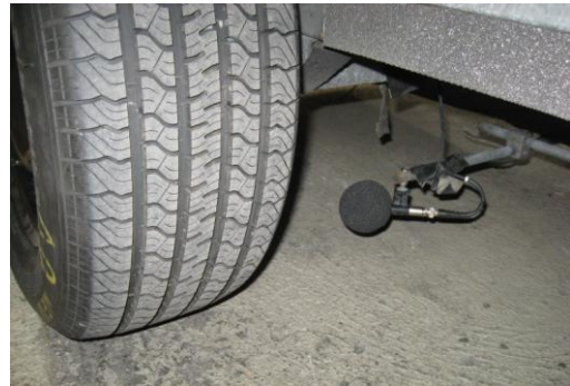
Abbildung 3. Reifen A mit Messmikrofon (Mikrofonposition vorne).
