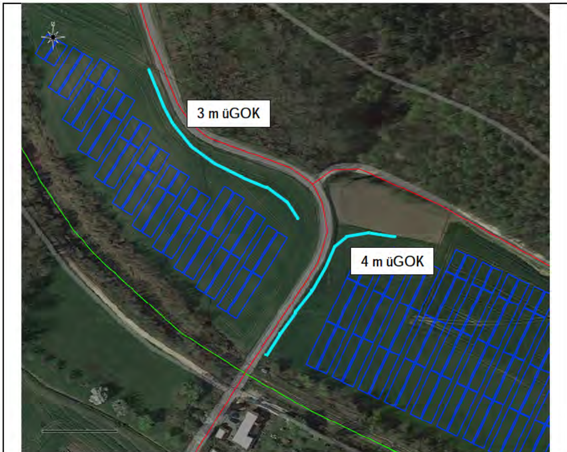
Abbildung 6: Lage und Abmessung einer möglichen Sichtunterbrechung zum Schutz der Verkehrsteilnehmer auf der Kreisstraße K 6163
